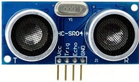
Sensor ultrasónico HC-SR04
